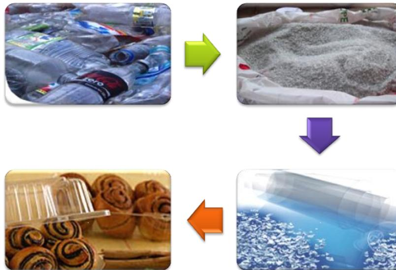
A fines de 2012, en línea con sus planes de incorporar en su portafolio un mayor volumen de productos fabricados a partir de materiales reciclados, PAMOLSA se integró hacia atrás, adquiriendo una línea de reciclado y lavado en caliente para procesar su propia materia prima a partir de botellas de PET recolectadas. La línea cuenta con una capacidad de procesamiento de cerca de 3.000 toneladas al año y estimamos que estará ocupando su capacidad en un 100% a mediados de 2014.
